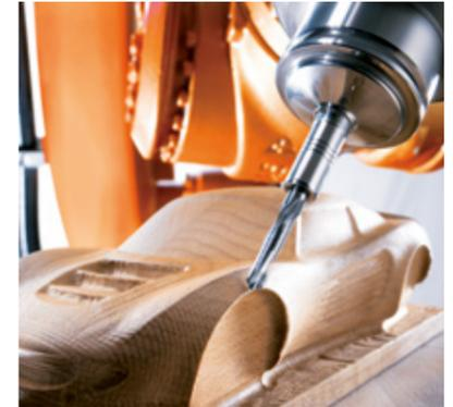
Direkte Ausführung von allen Norm-G- und M-Befehlen für Toolhandling und HSC (High Speed Cutting).
